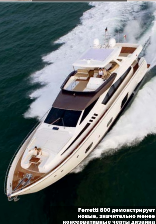
В жесткую крышу флайбриджа встроен опциональный открывающийся люк с электроприводом
