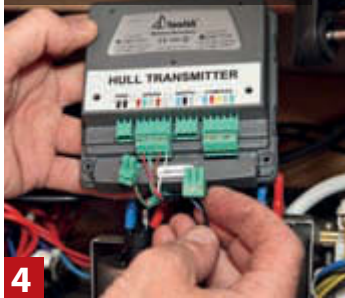
Подключите кабели к распределительной коробке
