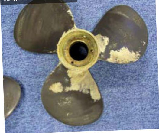
Оригинальные винты, съеденные коррозией...
