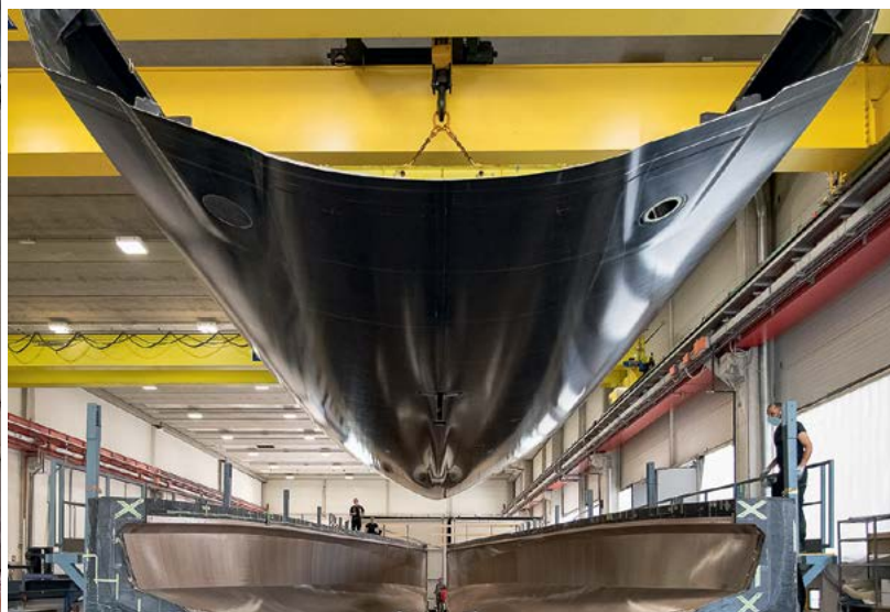
Корпус ClubSwan 80 извлекли из матрицы и перемещают на тельфере для дальнейших монтажных работ
