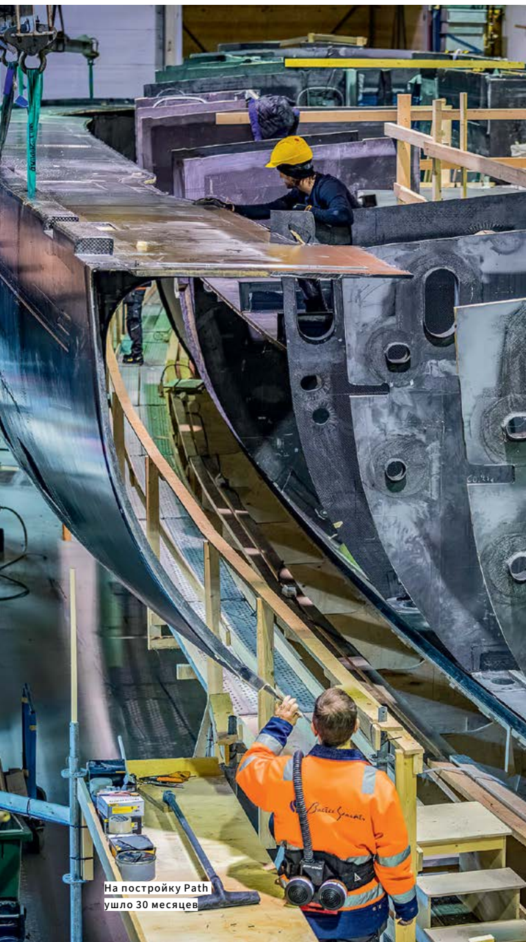
Матрица, в которой из углеволокна отформовали нижнюю часть корпуса
