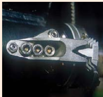
Неподвижная часть ножиц привинчивается к кронштейну
