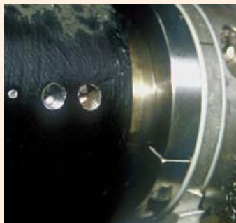
В кронштейне вала сверлятся отверстия
