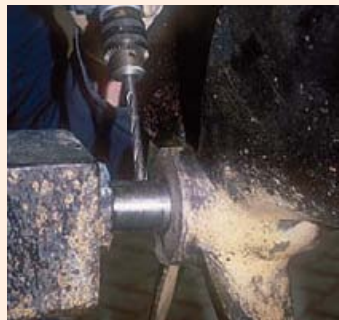
Половинки снимаются, сверлится неглубокое отверстие
