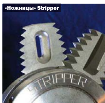
Оба типа хорошо справляются с мелким мусором, но в сложной ситуации «ножницы» предпочтительнее
