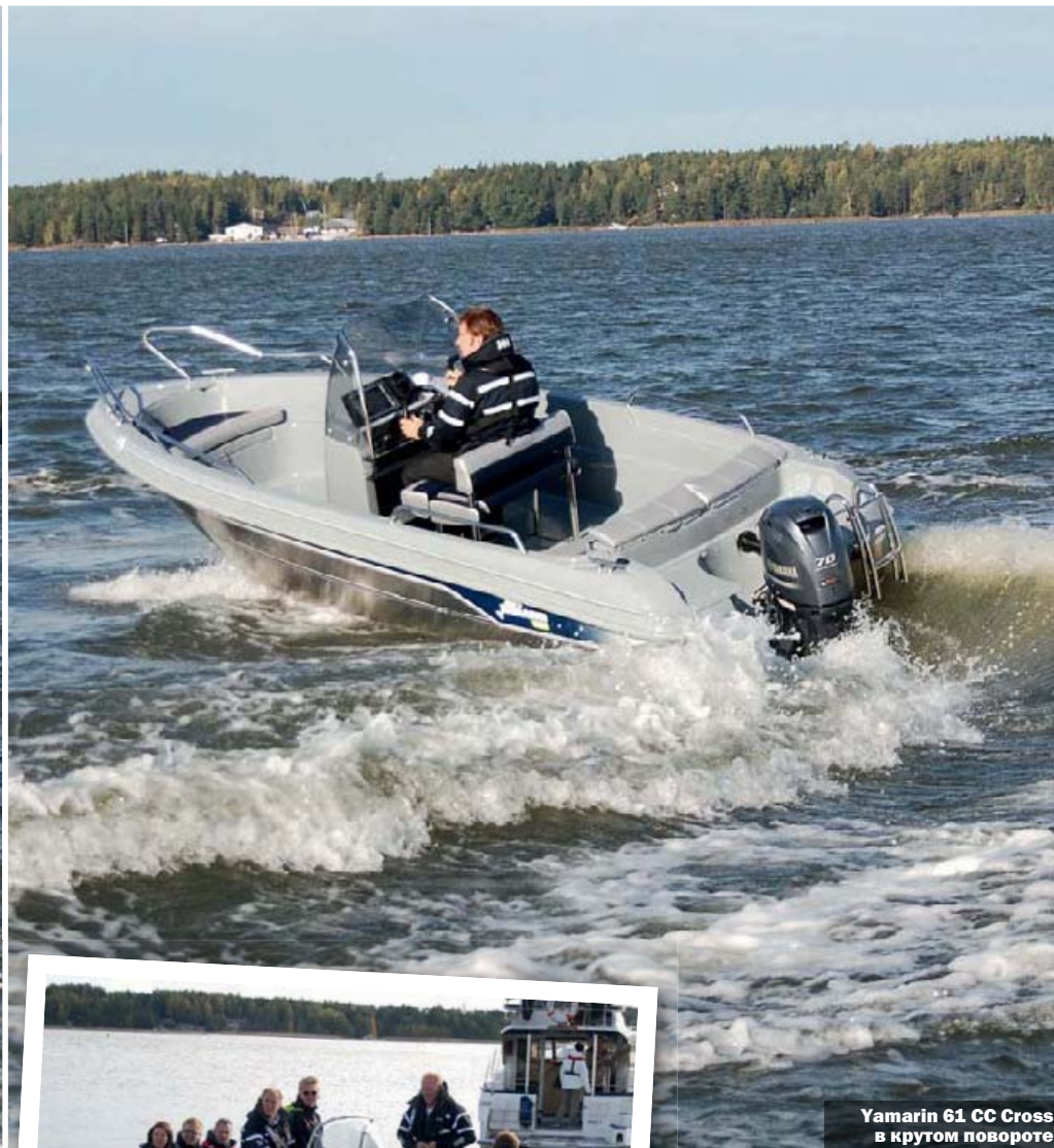
Yamarin 61 CC Cross — прыжок на волне (хорошо видны скула, реданы и даже качество сварки)
