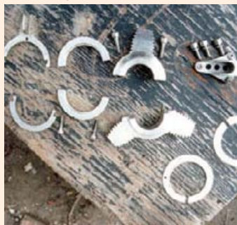
Типовой набор деталей для установки ножа (в этом случае Ambassador Marine Stripper)
