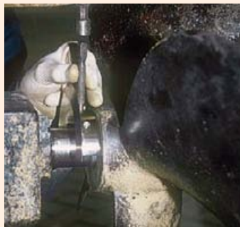
Половинки ножа собирают на валу, керном ставится отметка для высверливания отверстия
