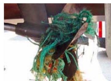
Оба типа хорошо справляются с мелким мусором, но в сложной ситуации «ножницы» предпочтительнее
