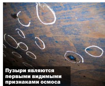
Грязь и неотвержденные волокна в ламинате притягивают влагу
