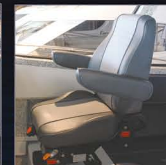
кресло водителя с амортизаторами
