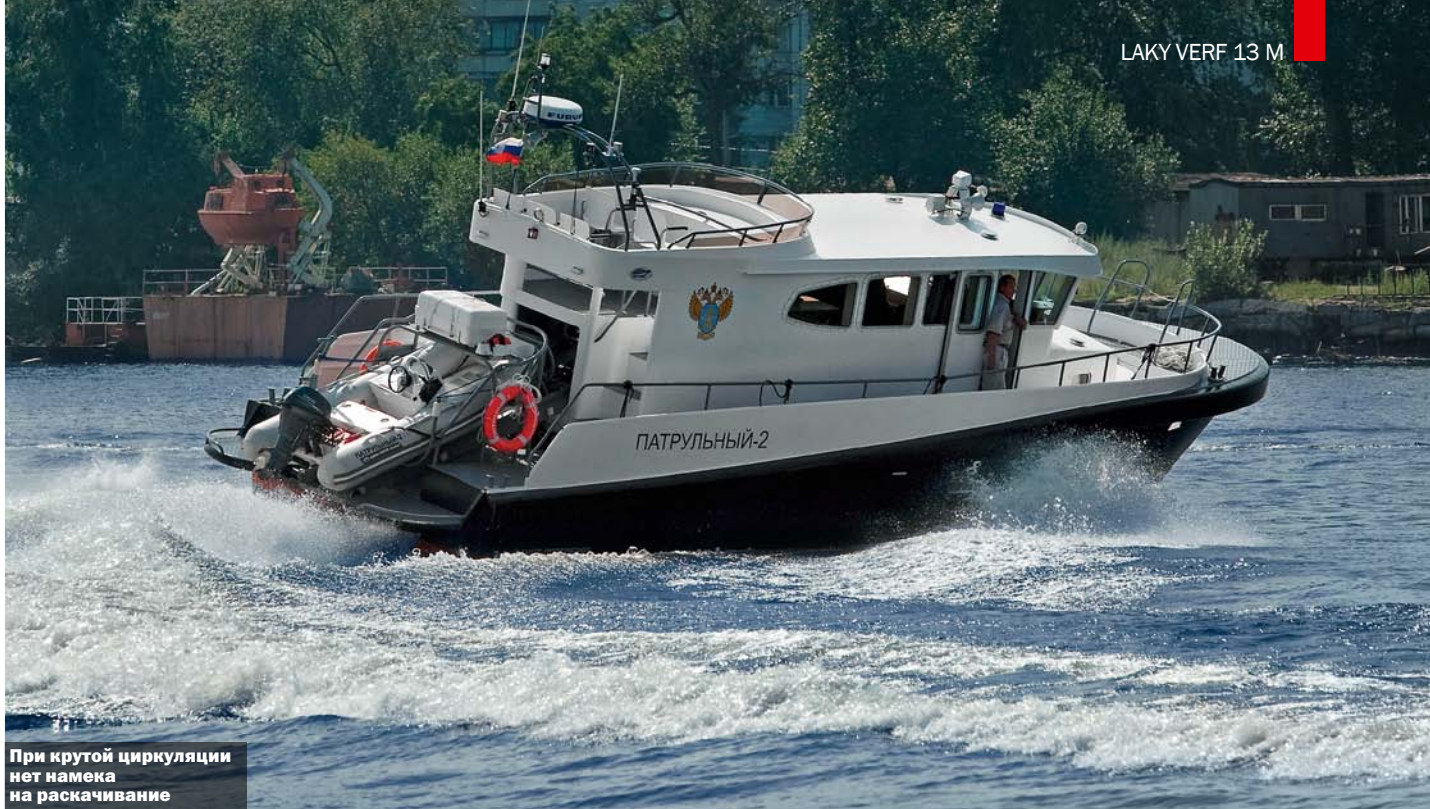
Усиленный фальшборт, крепкий высокий релинг и широкие боковые проходы обеспечивают безопасность на палубе
