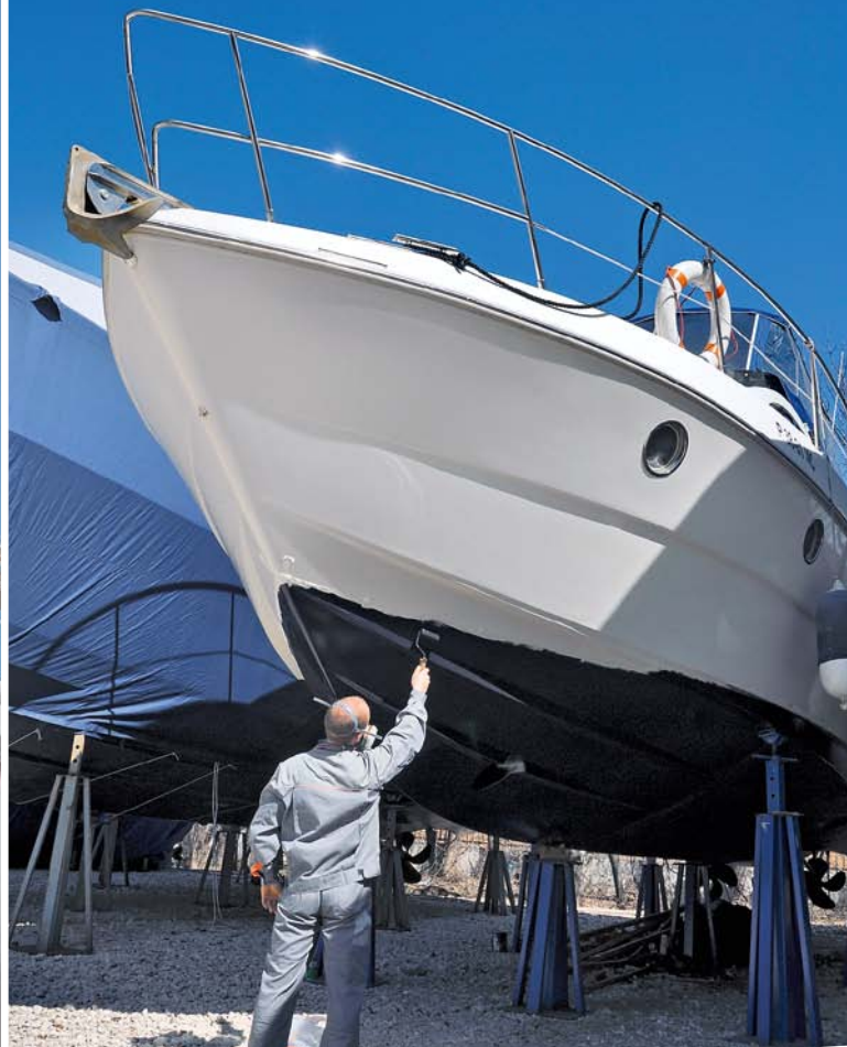
Антифоулинг не обязательно наносить заново — иногда его достаточно просто обновить
