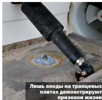
Анод с корпуса исчез полностью
