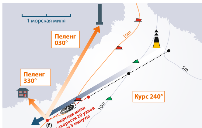
РИС. 6 По завершении третьего 3-минутного отрезка точно справа по борту будет большое здание
