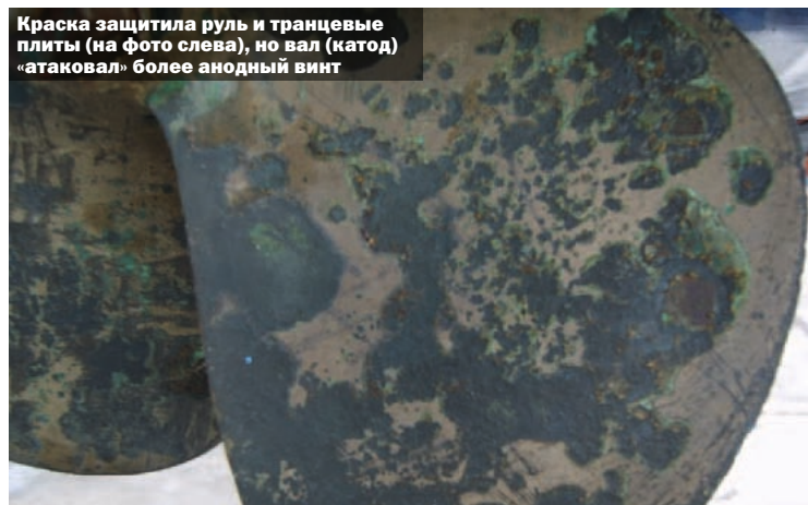
Гальваническая коррозия повреждает приводы как стальных, так и стеклопластиковых лодок, если они должным образом не защищены
